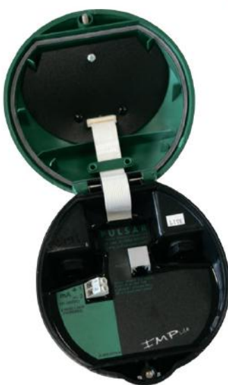
ВНУТРЕННЕЕ УСТРОЙСТВО УРОВНЕМЕРА IMP LITE, ГДЕ ВИДНО РАЗЪЕМ RJ11
