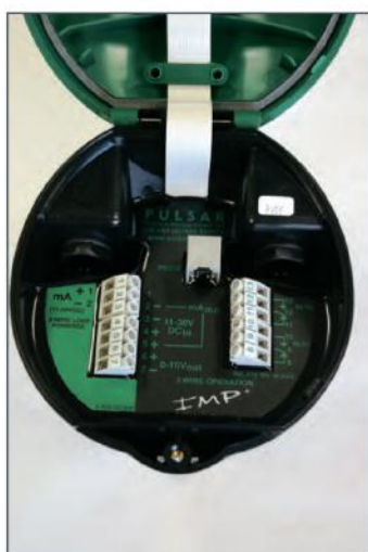
ВНУТРЕННЕЕ УСТРОЙСТВО СТАНДАРТНОГО 2/3-ПРОВОДНОГО УРОВНЕМЕРА IMP
