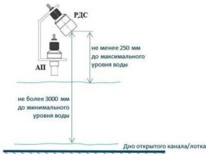
Рисунок 16 – Ограничения на линейные параметры монтажа РДС на монтажном кронштейне с АП
