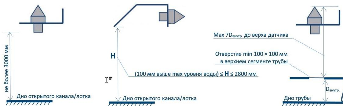
Рисунок 15- Ограничения на линейные параметры монтажа АП
